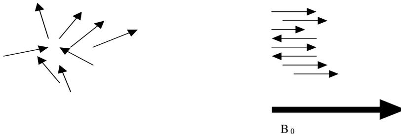
Abb. 5.6.1.1: Stark vereinfachte Darstellung zum Ausrichten der Elektronenspins vor (links) und nach (rechts) dem Anlegen eines magnetischen Feldes der Induktion  $B_0$
