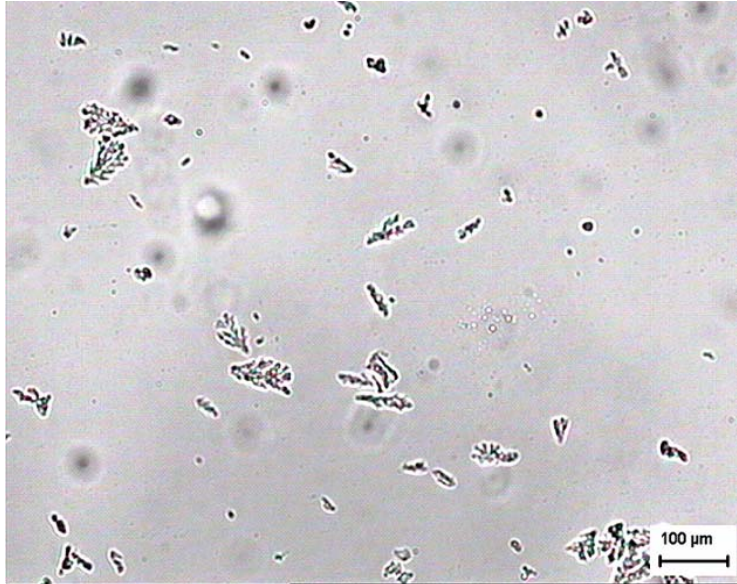
Abb. 3.1.2.5.3. Mikroskopisches Bild der Ölphase der positiv geladenen Nanoemulsion mit 0,8 % Phytosphingosin und ohne die Lipide Ceramid 3, Ceramid 3B, Palmitinsäure und Cholesterol nach einwöchiger Lagerung bei Raumtemperatur (20fache Vergrößerung)
