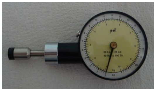
Abbildung 15: Darstellung eines Algometers zur Messung der Schmerzschwelle und Schmerzgrenze {Quelle: eigene Fotoaufnahme des für die Studie verwendeten Algometers von Pain, Diagnostic & Treatment}
