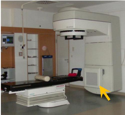
**Abbildung 3: Linearbeschleuniger mit eingefahrenem EPID (Pfeil)**
