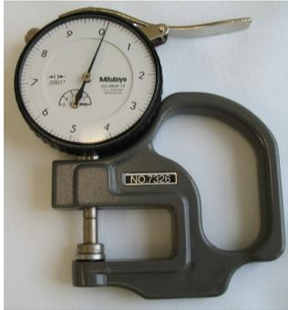
**Abb. 9: Foto des eingesetzten abgefederten Messgerätes.**
