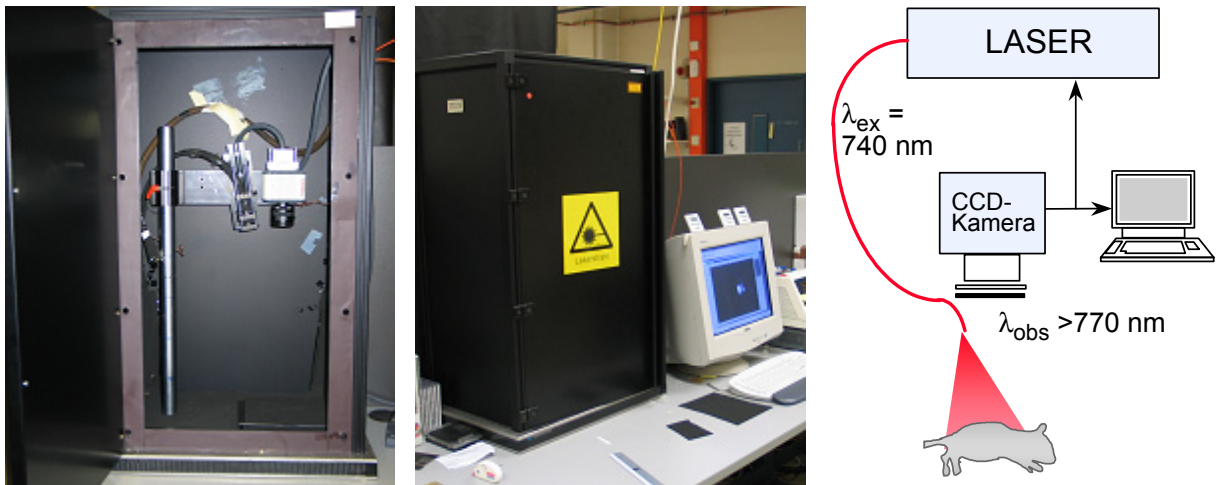
Abb. 135 a) geöffnete Laser-Imaging Box; b) Imagingbox / rechnergestützte Datenaufarbeitung; c) schematische Darstellung der Einzelkomponenten
