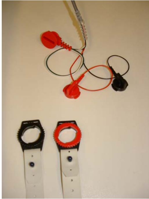
Abb. 3: Analysesensorstecker (rot mit Schlitz für den Einweg-Sensor), Iontophoreseelektroden (schwarz = Kathode und rot = Anode), Elektrodenhalter mit Band und Arrettierungsring
