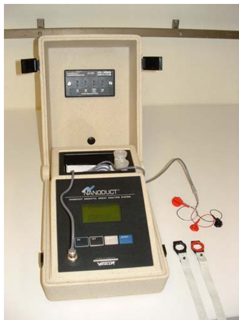
Abb. 2: Induktions- und Analysenmodul, kombiniertes Elektroden- und Sensorkabel mit Analysesensor und Iontophoreseelektroden mit Anschluss an das Gerät über den Sensorstecker, Elektrodenhalter
