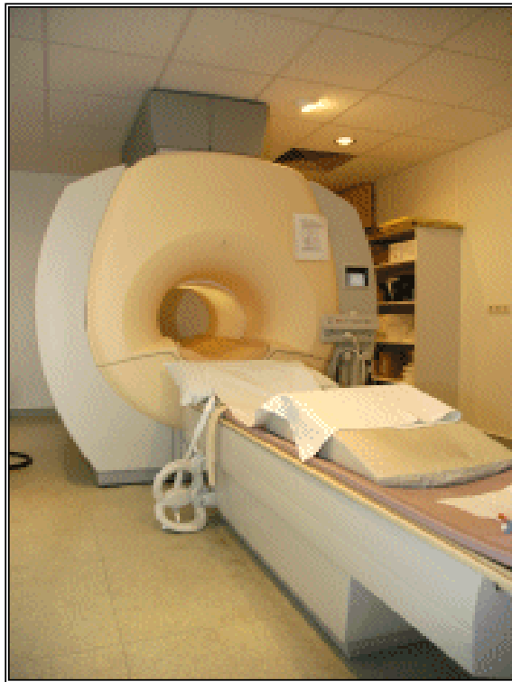
Abbildung 12: Ganzkörper-Magnetresonanztomograph mit 1,5 Tesla, Radiologie, Universitätsklinikum Charité, Campus Virchow Klinikum, Berlin, Deutschland
