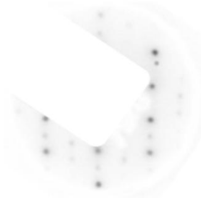
Abbildung 73: Invertierte LEED-Aufnahme der c(2 \times 4) Sauerstoffphase nach 3 Stunden Stehenlassen bei 300 K und p = 4 \times 10^{-10} mbar ( E_p = 100 eV).
