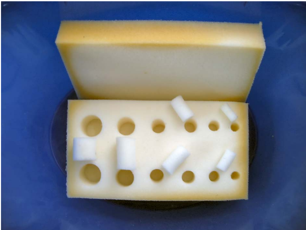
Abbildung 4: Materialien des Niedrigkontrastphantoms: Polyamidschwamm und Kunststoffwanne
