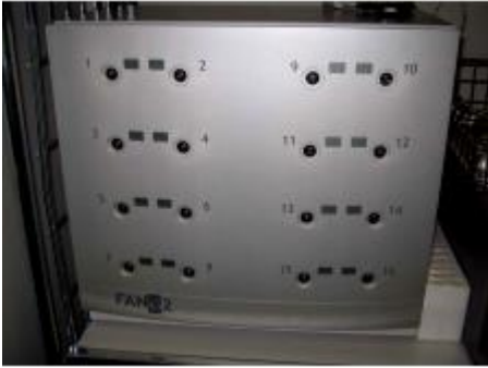
Abbildung 7: NDIRS-Messgerät FANci2db16., FAN GmbH, Leipzig
