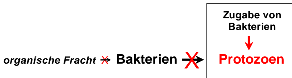
Abb. 9: Als Lösungsansatz zu Grunde gelegtes Testprinzip. Nach Entnahme ist die Belebtschlammprobe von der Nährstoffzufuhr abgeschnitten. Durch ausschließliche Zugabe von Bakterien wird selektiv die partikuläre Nährstoffzufuhr der Protozoen gesteuert.
