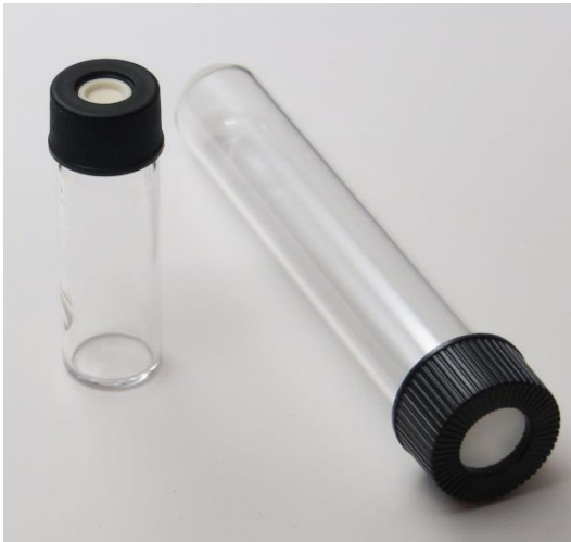
Abb. 11: Teströhrchen mit einem Gesamtvolumen von 4 mL (links) bzw. 12 mL (rechts). Beide Röhrchen bestehen aus Glas und sind mit einer sauerstoffdurchlässigen Schraubkappe verschließbar.
