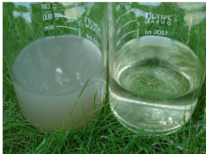
Abb. 1: Verschmutztes, trübes Abwasser vor der Reinigung im Anlagenzulauf (links) und „geklärt“ nach der Reinigung im Anlagenablauf (rechts).
