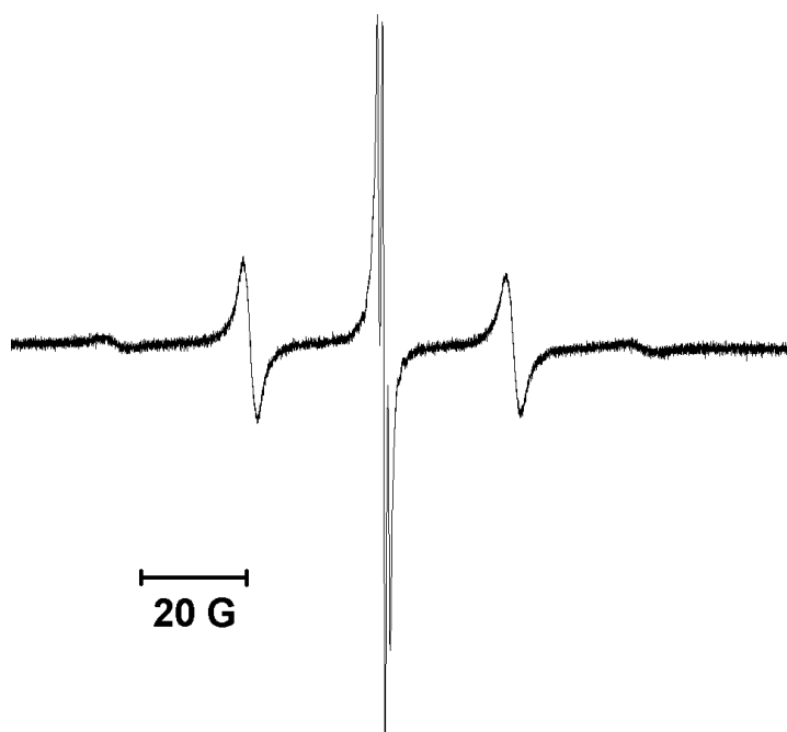
Abbildung 8: Das ESR-Spektrum des 1,2,4,5- \text{C}_6\text{H}_2\text{F}_4^+ -Kations in \text{SO}_2 bei -70\text{ }^{\circ}\text{C} .
