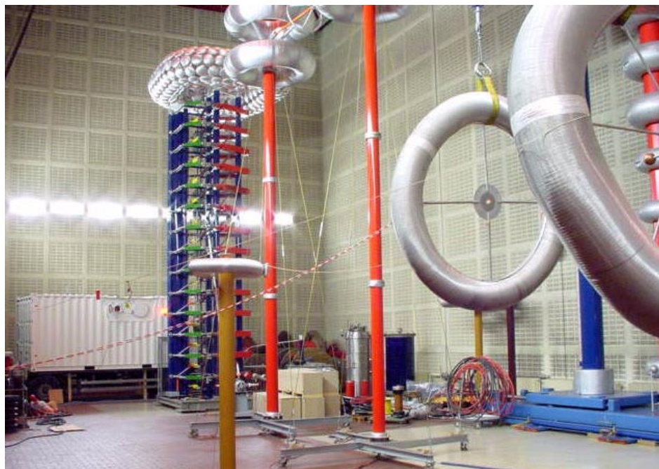
Bild 2-19. Das Teramobile (am linken Rand) in der Hochspannungshalle der TU Berlin. Direkt daneben der 14-stufige Marx-Generator. Am rechten Rand Versuchsaufbau mit torusförmigen Elektroden. (Vergleiche schematische Darstellung in Bild 2-21.)
