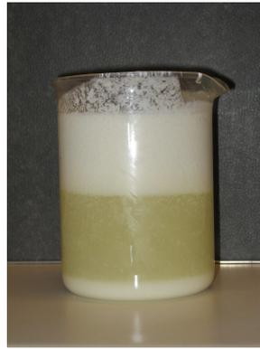
Abb. 50 ORT-3A<sub>MAT</sub> nach Zugabe von HCl auf pH≤4,7
