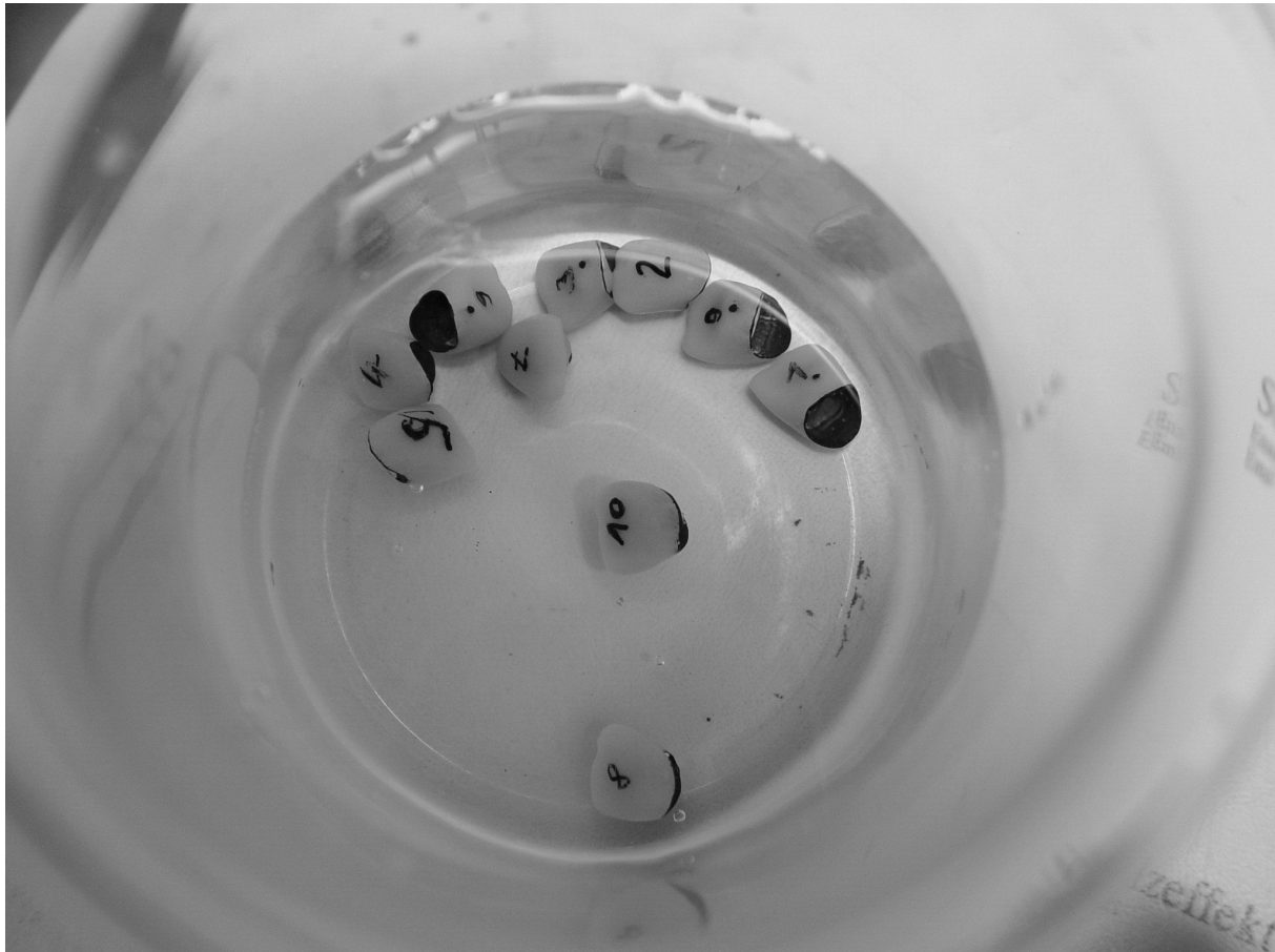
Abb. 10: Kronen einer Serie n = 10 nach Abschrecken in 5 °C kaltem Wasser
