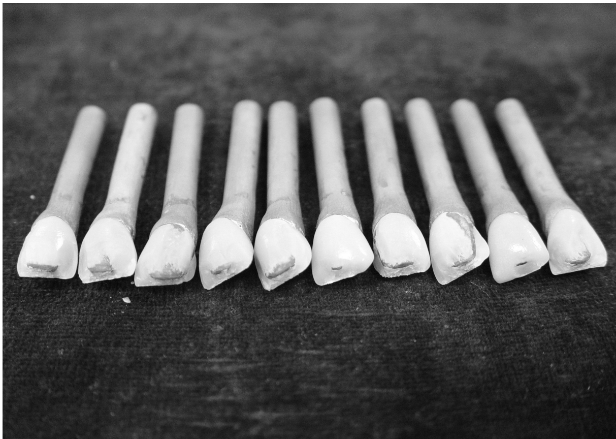
Abb. 5: Auf die Prüfstümpfe aufzementierte Kronen nach dem VOSS-TEST in der Ansicht von labial
