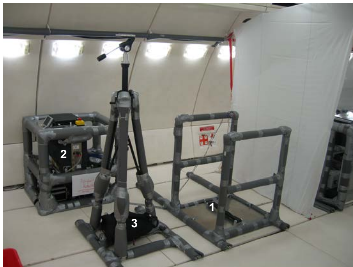
Abbildung 3.5: Linkes Bild: Messplatz im Airbus A300 ZERO-G mit (1) Probandenstehplatz, (2) Gewebe-Photospektrometrie-Messgerät, (3) Infrarotwärmebildkamerastativ. Rechtes Bild: Proband mit Operator während Messung in Mikrogravitation.
