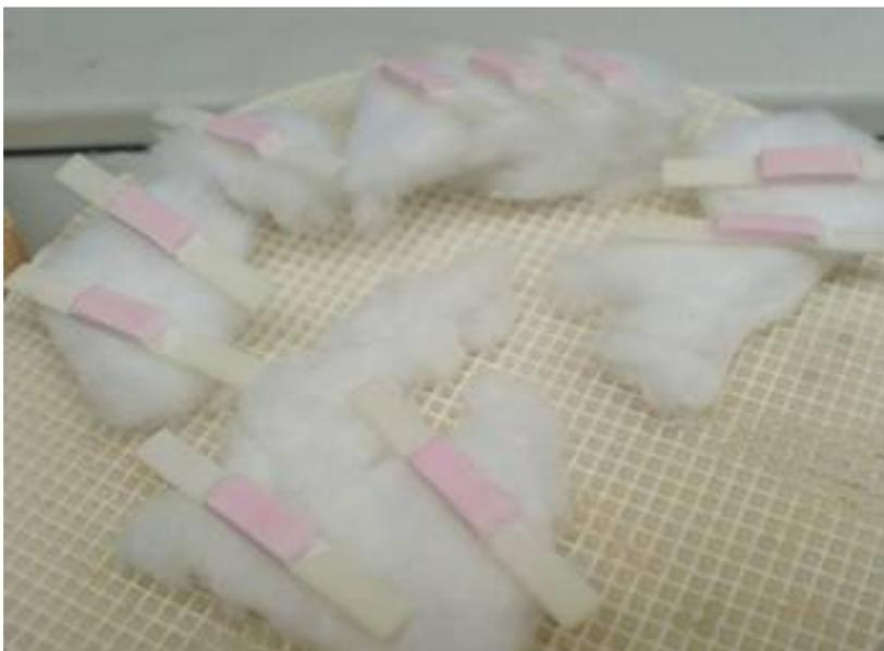
17. Abbildung: Proben auf Brennträger vor dem ersten Dentinbrand
