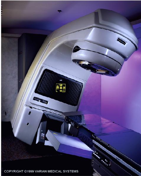
**Abbildung 4: Linearbeschleuniger mit *Mark2 LC250® portal imager*. ©1999 Varian Medical Systems. Der Linearbeschleuniger (weiss, C-förmig) kann rotiert werden, oben sichtbar der Gerätekopf, der den Kollimator enthält. Die weisse Platte am unteren Schenkel des Gerätes entspricht dem *Mark2 LC250® portal imager*. In schwarz, horizontal ist die Patientenliegefläche erkennbar.**
