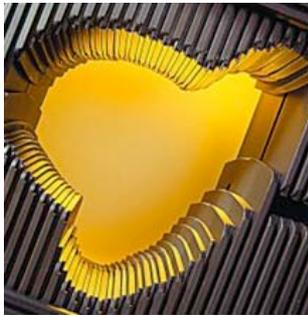
**Abbildung 1: Dynamic Motion Leaf Collimator (©Varian Medical Systems). Erkennbar hier die Kollimatoröffnung, die durch Beweglichkeit der einzelnen Lamellen („Leafs“) variiert wird.**
