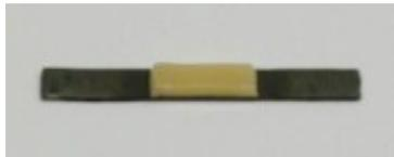
**Abbildung 13: Fertiger Metall-Keramik-Prüfkörper in der Aufsicht**
