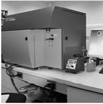
**Abb.11:** FACS CANTO II Gerät mit Durchflusszytometer links, Vortextmischer mittig und am rechten Bildrand PC mit Auswertungsprogramm
