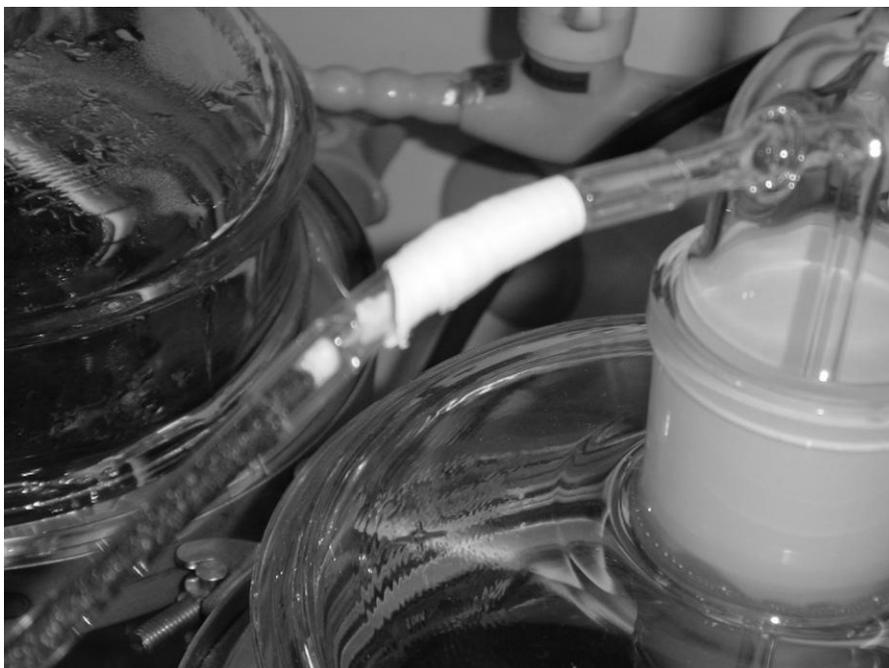
Abb.2-8: Abgedichtete Beimpfungsstelle für die Dotierlösung
