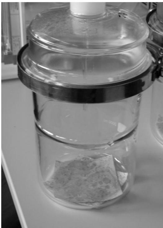
Abb.2-1: Beimpfte Raufasertapete in Prüfkammer
