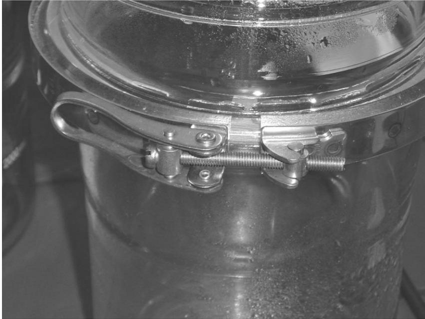
Abb.2-3: Verschluss der Prüfkammer
