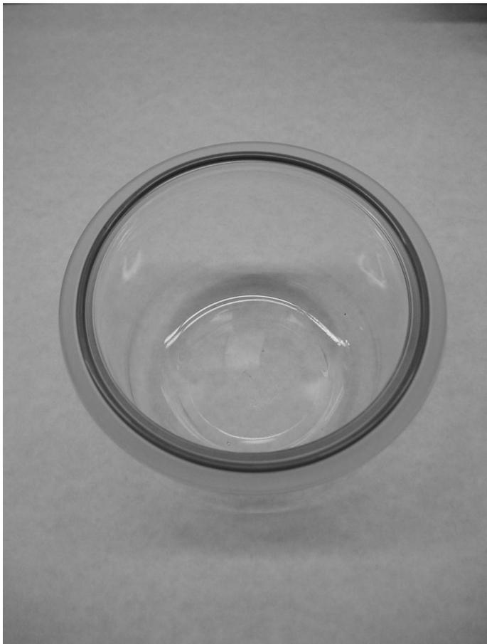
Abb.2-2: Dichtungsring im Schliff des Prüfkammerunterteiles
