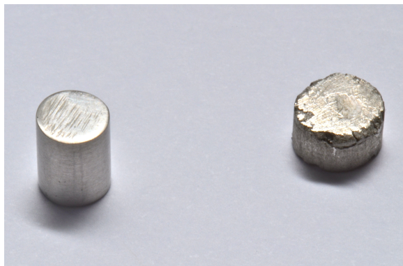
Abb. 16: Zylinderförmige Testkörper aus Stahl (links) und Amalgam (rechts)
