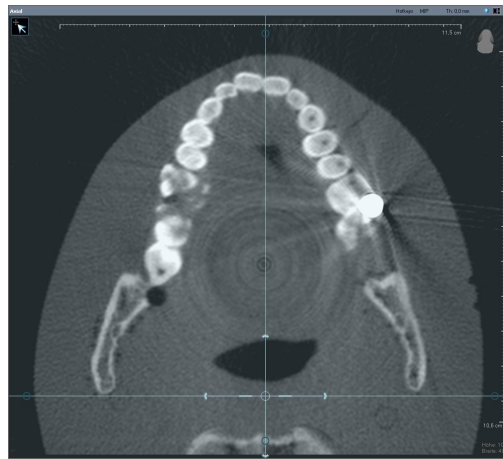
Abb. 11: Ringartefakte an Alderson-Phantom 2 (axiale Schicht mit Amalgamzylinder in Horizontallage, 1.0 mA)
