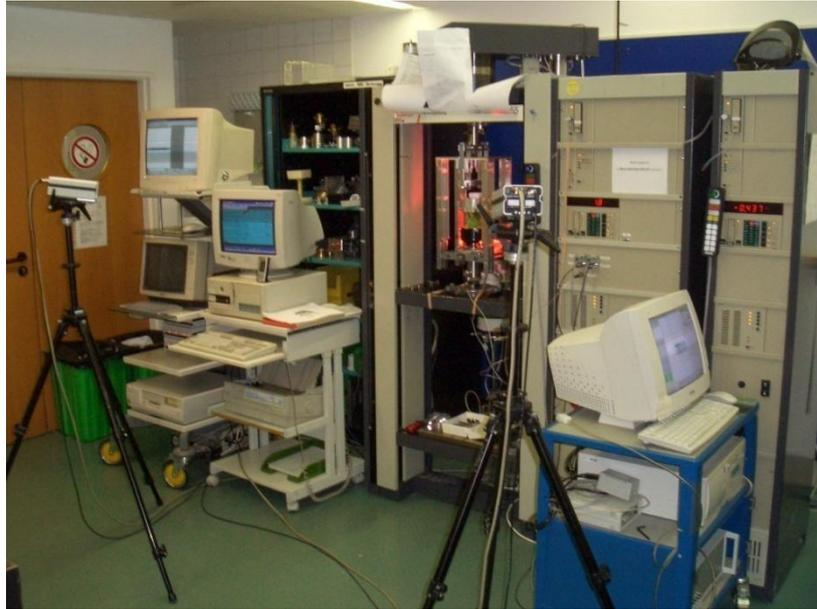
Abb. 23: Wirbelsäulenprüfstand in Zwick-Materialprüfmaschine mit angeschlossenen Rechnern und Kameras zur Datenerfassung
