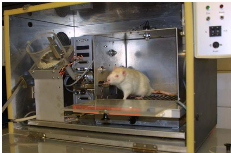
Die Frontseite besteht aus durchsichtigem, leicht getöntem Plexiglas und ermöglicht so die ungestörte Beobachtung des Tieres. Die umgebenden Wände sowie die Decke sind aus
