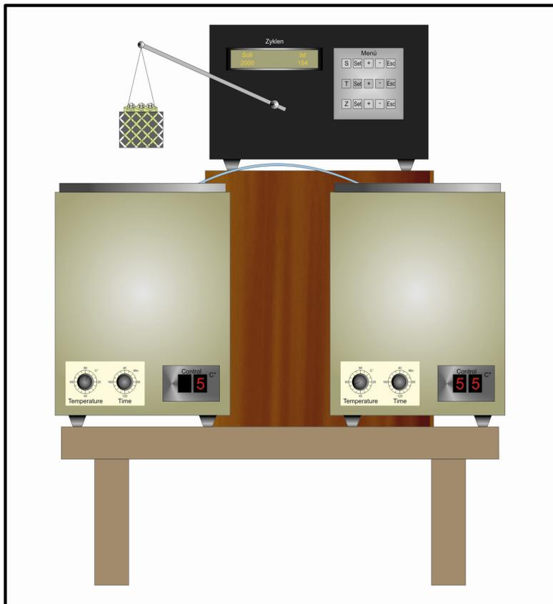
**Abb. 21** Schematische Darstellung des in dieser Studie verwendeten Gerätes für die thermozyklische Belastung
