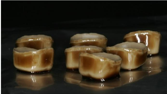
Abb. 14: CZ- Gerüste nach dem Infiltrationsbrand.
