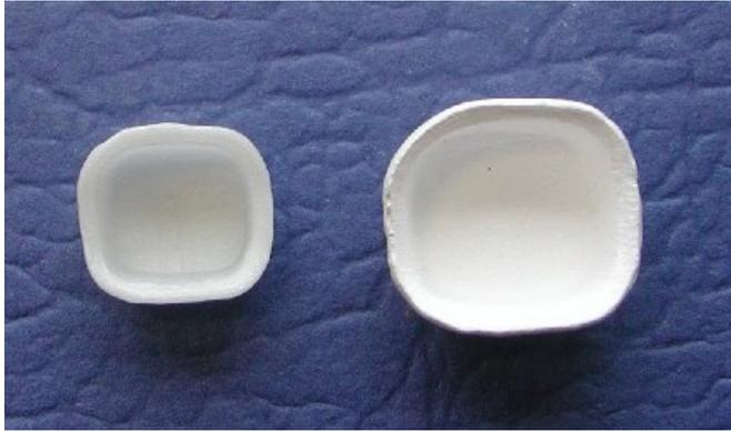
Abb. 16: YZ- Gerüste vor und nach dem Sintern.
