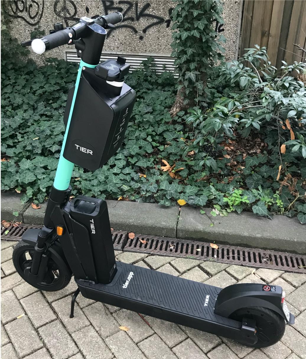
**Abbildung 8** Neue E-Scooter Generation mit beiden Bremsen am Lenkergriff, einer Blinkeranlage am Lenker zur Anzeige der Richtungsänderung, eine Smartphone-Halterung, einem ausklappbaren Helm sowie abgerundeten und abgedeckten Plattformkanten und Hinterradschrauben. (Foto: Deniz Uluk)
