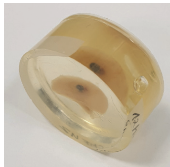
Abb. 35 Fertig ausgehärtete Probe
