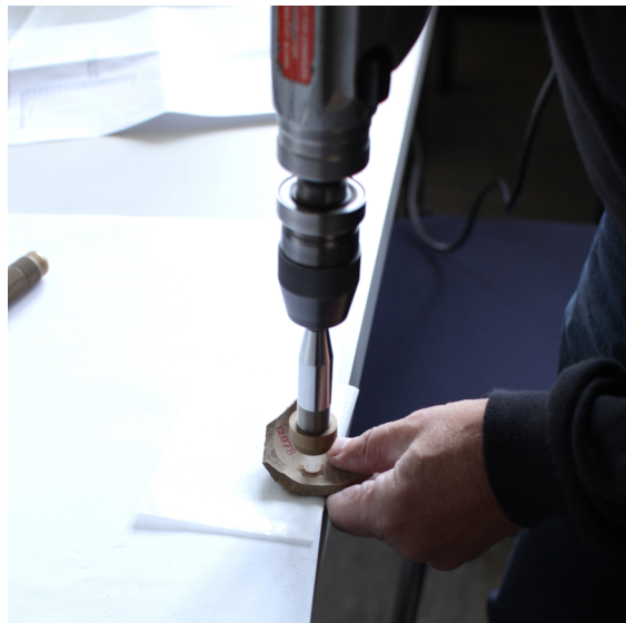
Abbildung 20: Reinigen und Gewinnung der Bohrprobe. Fotos: S. Nehls.
