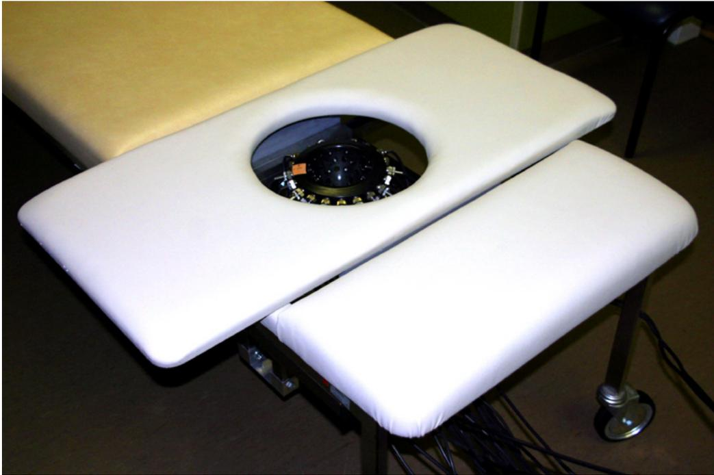
**Abbildung 4: Ansicht Patientenliege Kopfende:** Auf Brusthöhe der Liege befindet sich die verschiebbare Einheit mit gepolsterter Lochplatte, welche das Brustinterface (schwarze Glocke) enthält.
