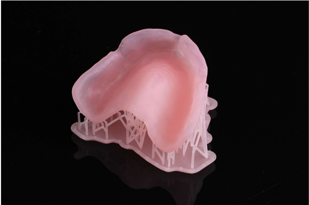
Abbildung 5: Darstellung einer im Stereolithografieverfahren gefertigten Prothesenbasis von basal (Quelle: Abbildung erstellt durch den Autor Gregor Wemken, 01.09.2021).
