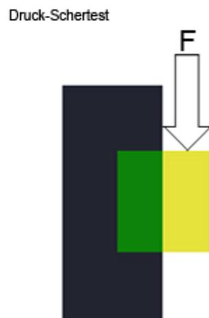
Abb. 11: Druck-Scherfestigkeitstest
