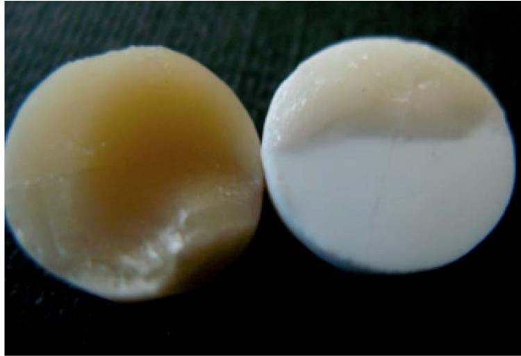
**Abb. 19: Aufnahme eines Probenkörpers nach Druck-Schertest**
