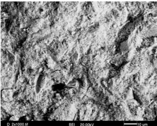
**Abb. 44: 110 µm Korundbehandlung vor Endsinterung (teilgesintert)**
