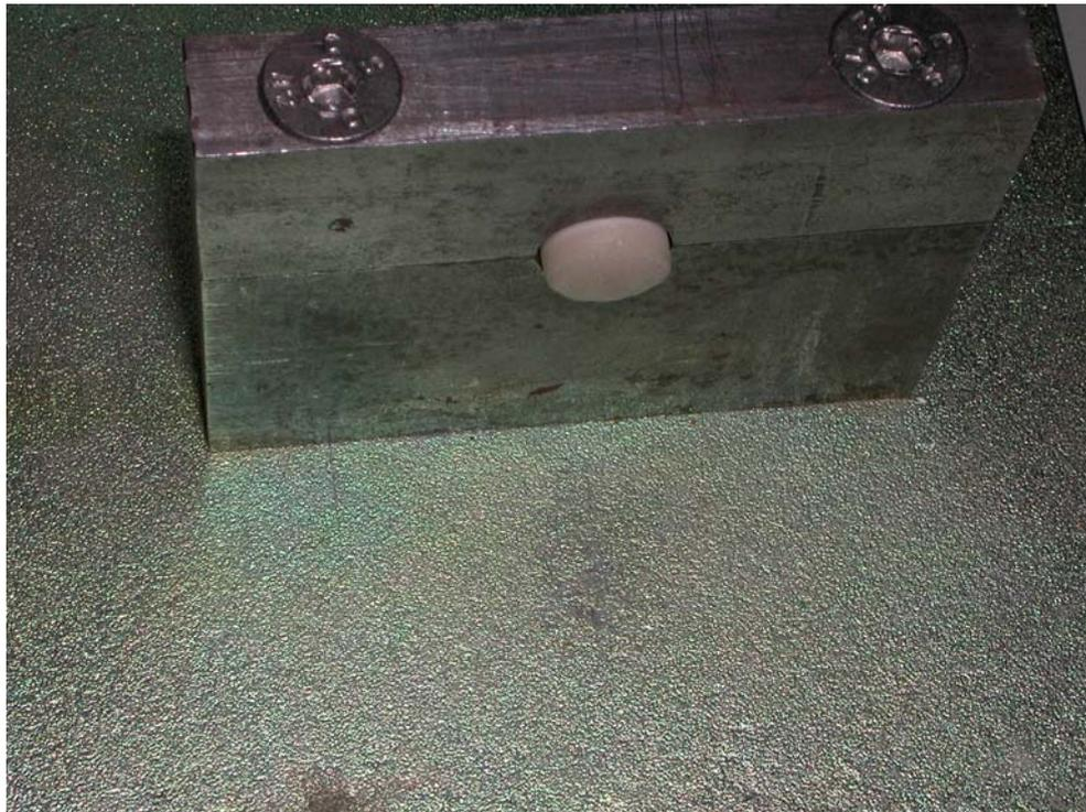
**Abb. 67: Prüfkörper in Einspannvorrichtung**
