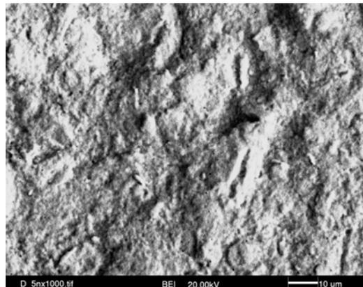
**Abb. 51:** mit Kalifeldspat behandelt nach Endsinterung
