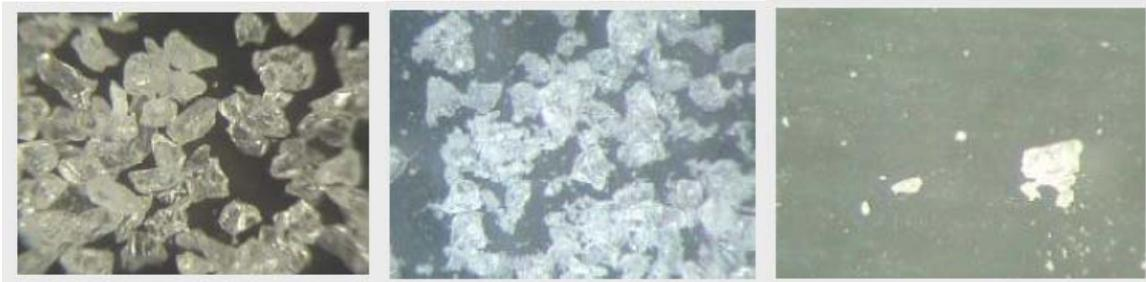
**Abb. 68:** von links: 250  $\mu\text{m}$ , 110  $\mu\text{m}$  Korund, Natronfeldspat in 40facher Vergrößerung
