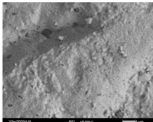
**Abb. 37: 250 µm Korundbehandlung nach Endsinterung**
