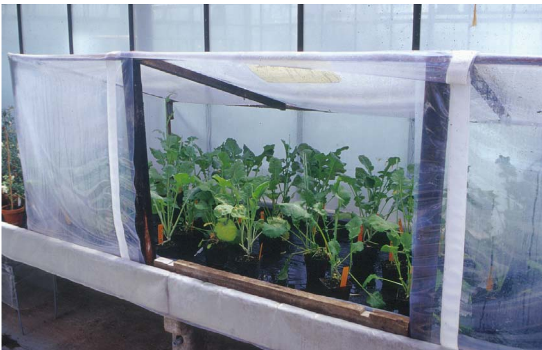
Abb. 2.2: Feuchtkammertest: Aufbau einer Feuchtkammer.
