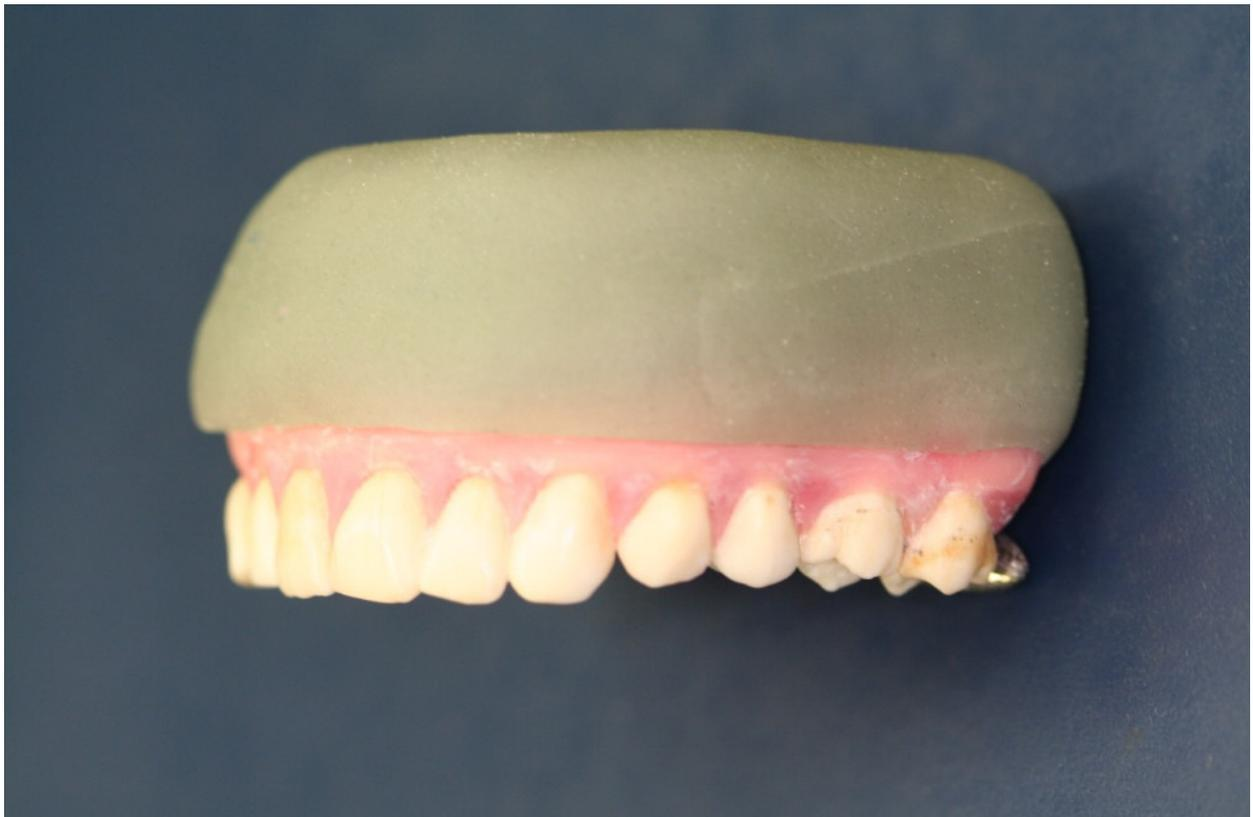
Abbildung 4: Fertiges Testkiefermodell mit modellierter Gingiva und Kunststoffsockel
