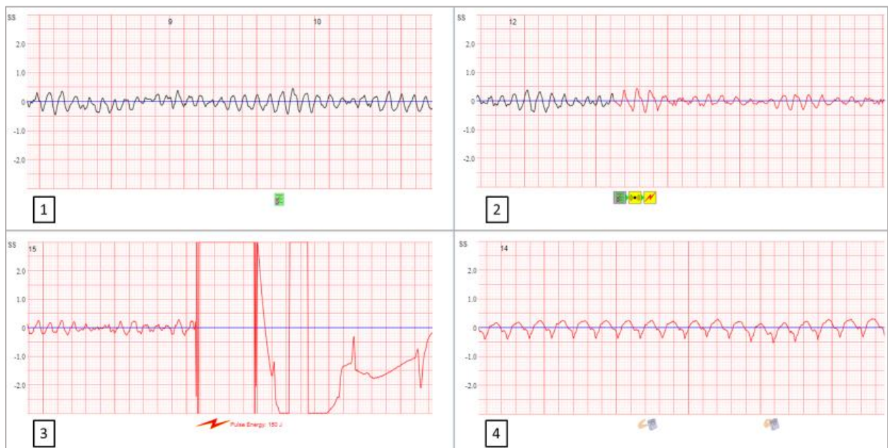
Abbildung 1: EKG-Beispiele für die Detektion einer Rhythmusstörungen [1], Initiierung eines Alarms [2], Abgabe eines Schocks [3] durch die LifeVest und manuelle Verzögerung einer Schockabgabe durch den Patienten [4].
