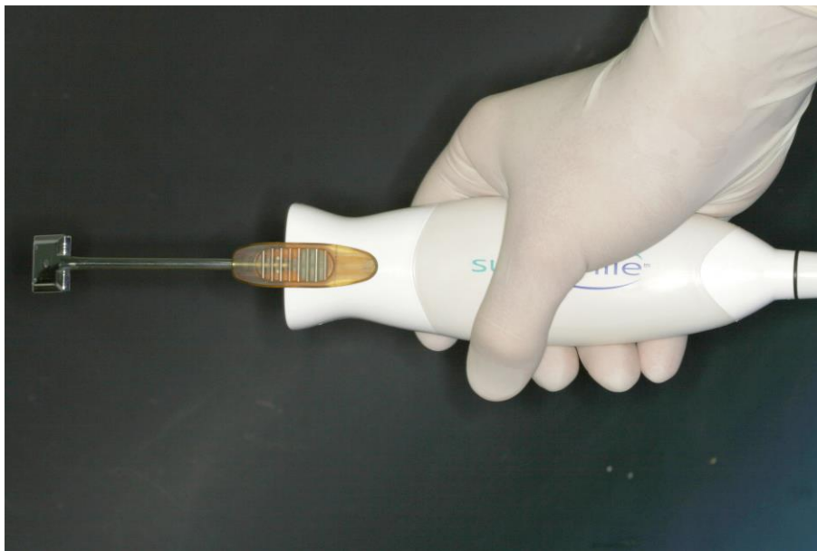
Abb. 3: Aufsicht auf den OraScanner ® mit viereckigem Umlenkspiegel links, an einem Griff fixiert.
