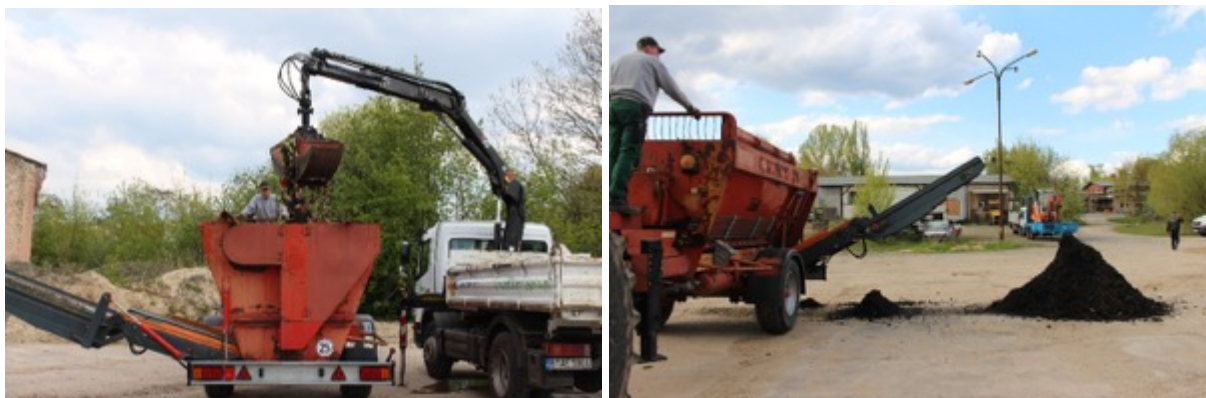
Abbildung 12: Beladen des Kompostmischers und Aufsetzen der Miete im Gutsgarten Hellersdorf
