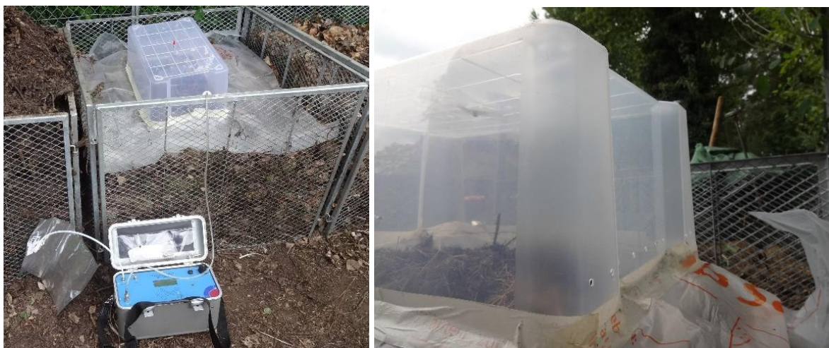
Abbildung 18: Haubenmessung vor Ort mit Messgerät und Gasbeutelprobenahme am Beispiel der Kompostierung am UBB (links), Haubenrückseite mit Luftzustromlöchern (rechts)
