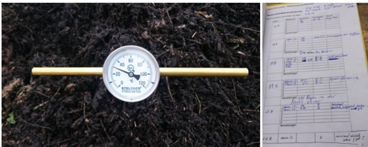
Abbildung 13: Thermometer zur Überwachung der Mientemperatur während der Kompostierung und Mietenprotokoll zur Dokumentation von Temperatur, Feuchte und Geruch
