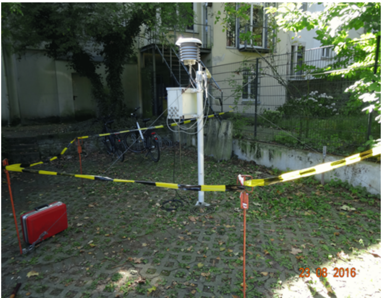
Abbildung 9: Messtation an der Königstraße mit Messhütte für die Lufttemperatur und Luftfeuchte.
