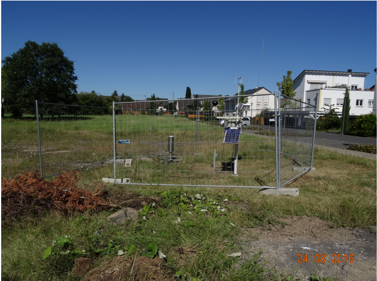
Abbildung 11: Lage der Messtation am Nelly-Sachs-Weg, Stationsmast mit Solarmodul, Datenlogger und Messsensoren für Temperatur und relative Feuchtigkeit in 2 m Höhe sowie Globe-Thermometer (schwarze Kugel) und Niederschlagstopf (Pluvio Ott) links vom Stationsmast.
