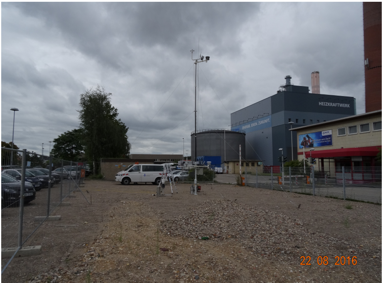
Abbildung 10: Messtation an der Karlstraße (hier Stationsmast mit Windmesser in 10 m Höhe für zusätzliche Vergleiche zu den Messungen in 2 m Höhe).
