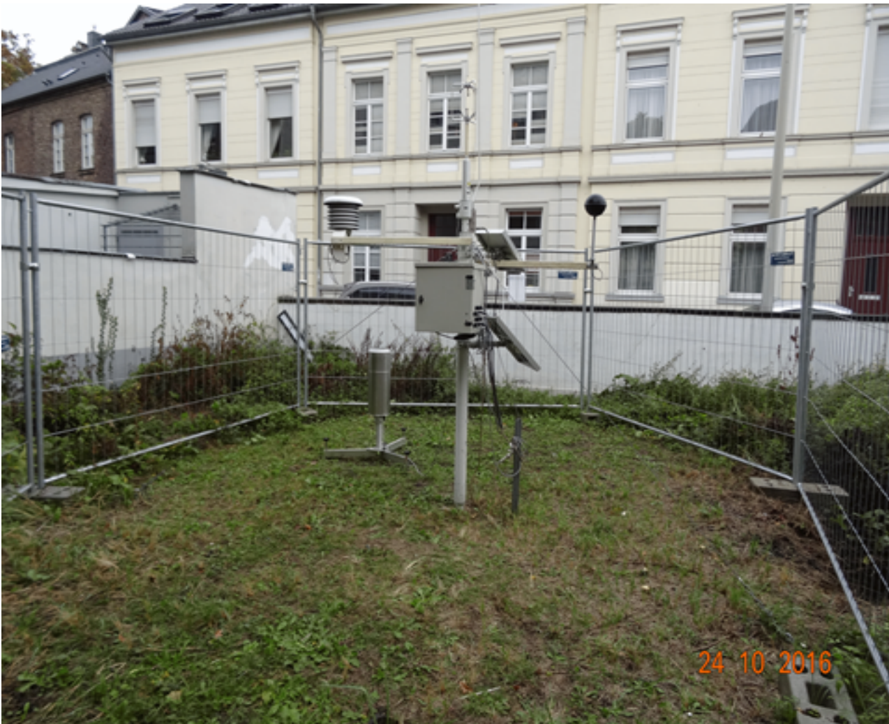
Abbildung 8: Temporäre Messtation Wilhelmstraße, Messaufbau: Messhütte mit Temperatur- und Feuchtemessung, Niederschlagstopf (Pluvio Ott), GLOBE-Thermometer für die Messung der mittleren Strahlungstemperatur (schwarze Kugel).
