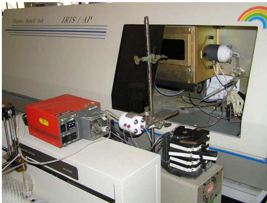
Abb. 4.15: Tandemzelle gekoppelt mit einem Autosampler und ICP-OES als Detektor.
