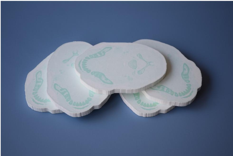
**Abbildung 4:** Photographie der fünf durch kombinierten 3D-Druck hergestellten Halsphantome.
