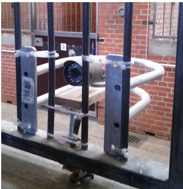
Abbildung 3: Aufhängung der Kamera zur Erkennung der Mimik an der Box.
