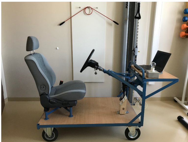
Abbildung 5 TÜV-zertifizierter Bremssimulator mit verstellbarem Autositz, Messrechner, Signalleuchte und Pedalen
