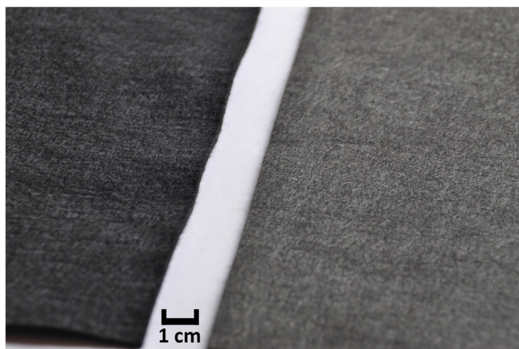
Abbildung 14: PAN-basiertes, stabilisiertes (links) und karbonisiertes Kohlenstoffvlies (rechts).
