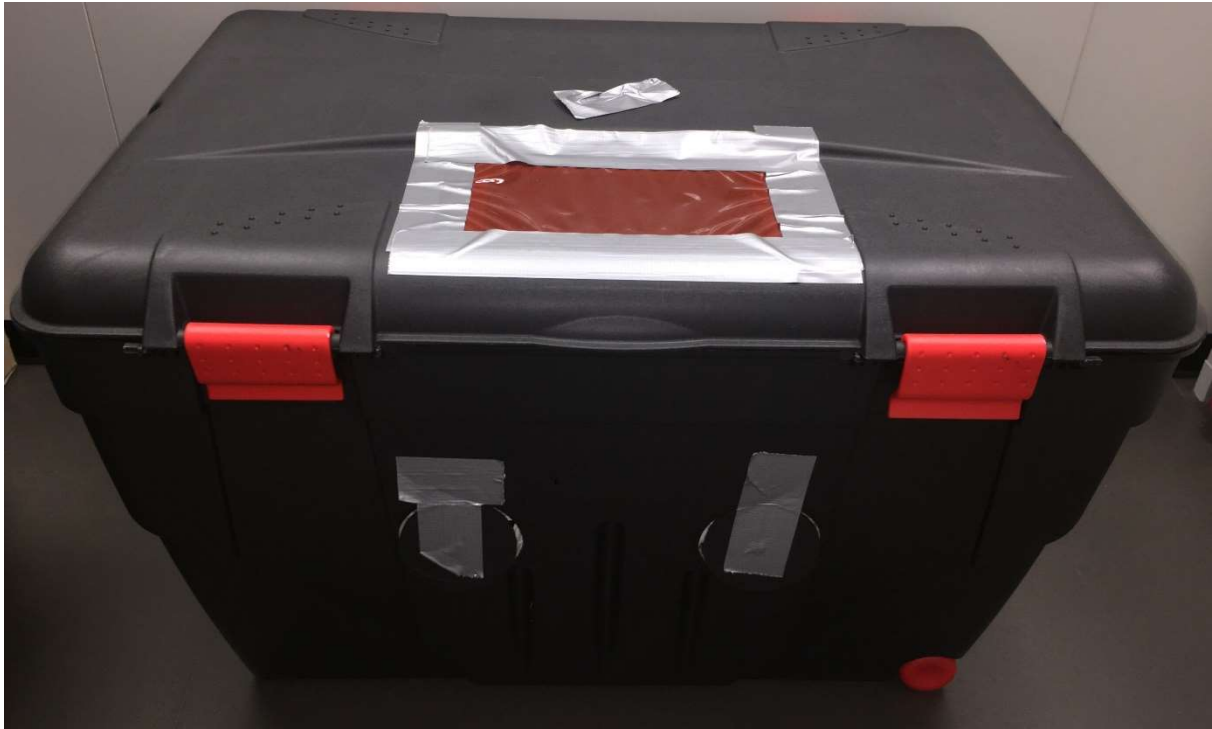
Abbildung 58 – Kunststoffbox mit Eingriffen und Sichtfenster zum Reinigen und Umfüllen der Silbernitratlösung unter weitgehendem Ausschluss von UV-Strahlung
