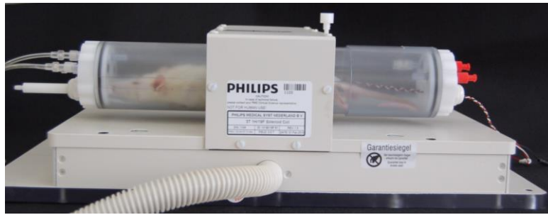
Abbildung 12: Darstellung der MRT-Narkose-Röhre. Zudem ist die 3T ^1\text{H}/^{19}\text{F} -MR-Kleintierspule der Firma Phillips mit Versuchstier von der Seite dargestellt. Eigene Abbildung. Abbildung im DHZB Jahresbericht 2013 publiziert. 61
