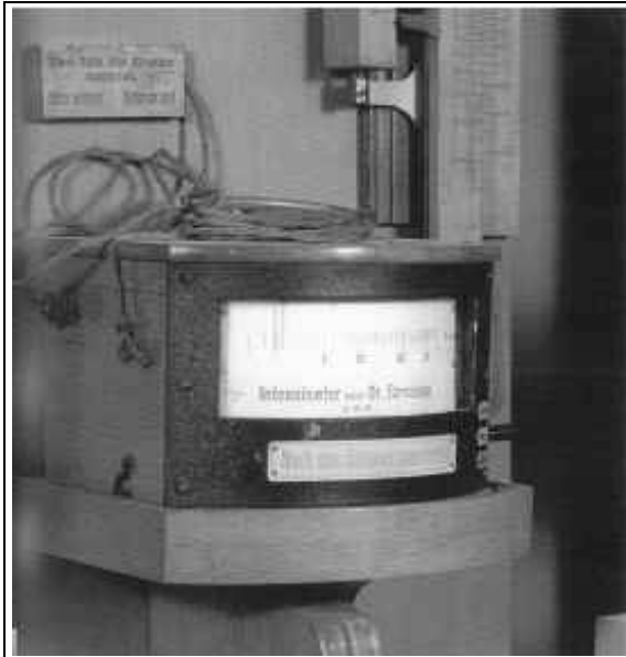
Abb. 22: Eines der ersten Strahlenmessgeräte: Das 1915 von Fürstenau entwickelte Dosimeter registrierte die Änderung der Leitfähigkeit des Halbleiters Selen bei einer Bestrahlung mit Röntgenlicht. (LOSSAU 1915 (119), S. 95)
