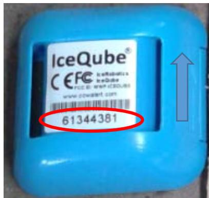
Abbildung 7. IceQube-Sensor ohne Klettband. Der Pfeil zeigt „oben“ an und hilft bei der richtigen Anbringung am Tier. Die eingekreiste Nummer ist die Sensor-ID, die mit dem ausgestatteten Tier in der Herdensoftware gekoppelt werden kann.
