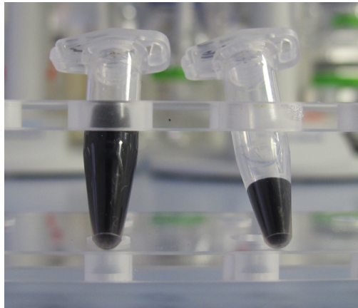
Abbildung 8: SPION-Suspensionen – Eppendorfgefäße mit den unverdünnten VSOP- (links) und Ferumoxytol-Lösungen (rechts) (Eisenkonzentration 409 bzw. 537 mM)
