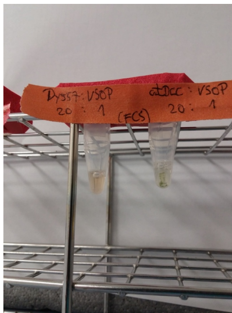
Abbildung 24: Dy557-TDP:VSOP und cIDCC-TDP:VSOP nach Resuspension mit fötalem Kälberserum (FCS)
