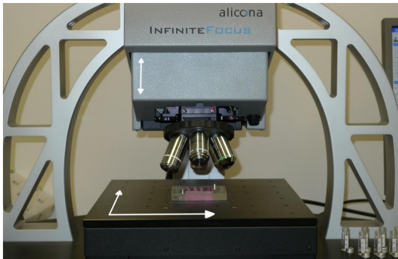
Abb. 2: Infinite Focus Mikroskop mit vertikal verschieblicher Präzisionsoptik und motorisiertem Tisch mit Rahmen für die Proben. Der motorisierte Tisch ist horizontal beweglich (siehe Pfeile).
